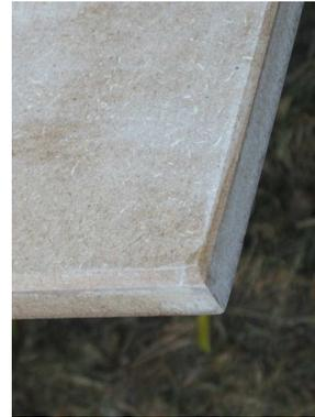
2. Alle Teile (Mini-Kommoden Frontseiten und MDF-Platten) mit 150er Schleifpapier anschleifen und mit Schnellschleifgrund behandeln. Nach Durchtrocknung mit 240er Schleifpapier wieder kurz überschleifen.
