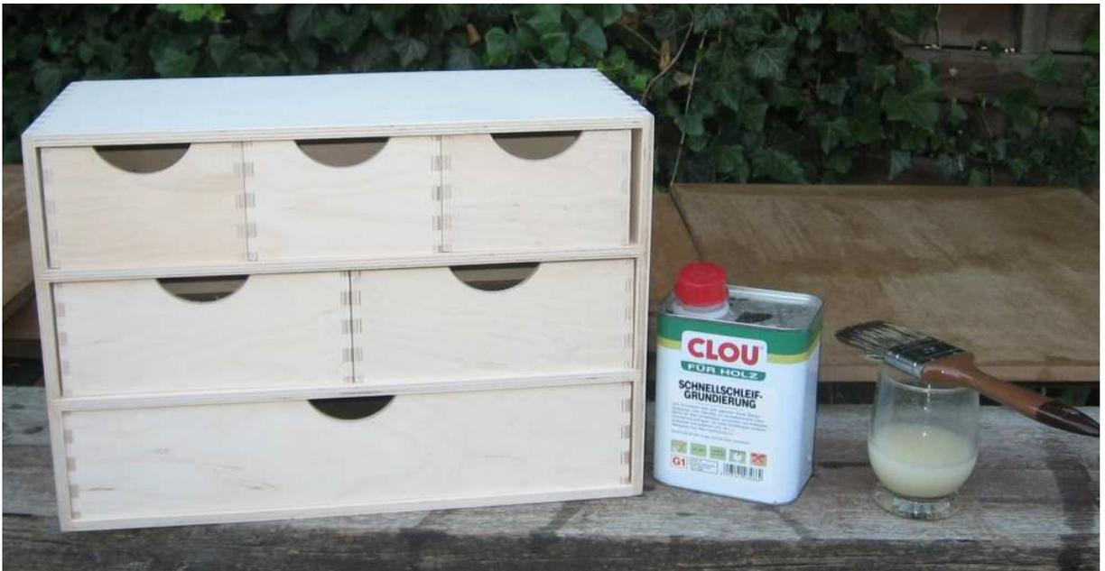
3. Dünne Farbschicht als zusätzliche Grundierung auftragen (braune Farbe), danach zweimal mit der Endfarbe behandeln. Zwischen den Farbaufträgen immer mit 240er Schleifpapier anschleifen.
